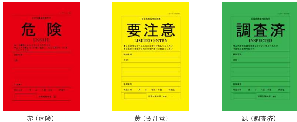
図表6 被災建築物応急危険度の判定ステッカーのサンプル 39
